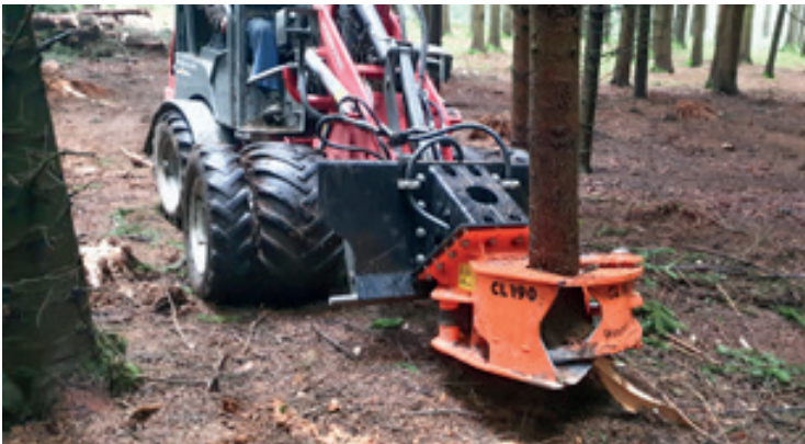
Woodcracker® CL190 schneidet weiches Holz bis zu 25 cm.
